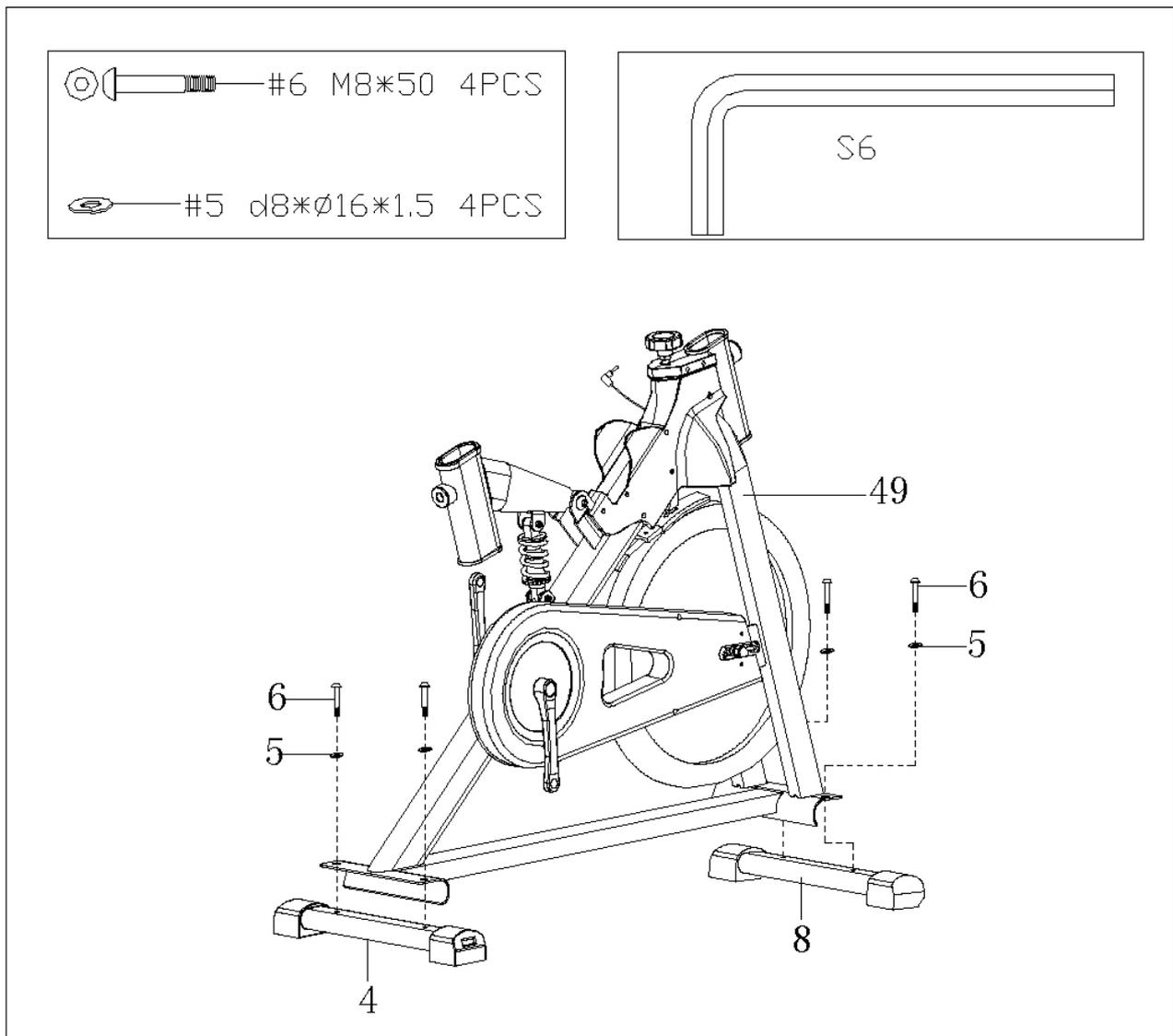
Usare il bullone ( 6 ) e la rondella ( 5 ) e avvitare lo stabilizzatore anteriore ( 8 ) e lo stabilizzatore posteriore ( 4 ) al telaio ( 49 ).
