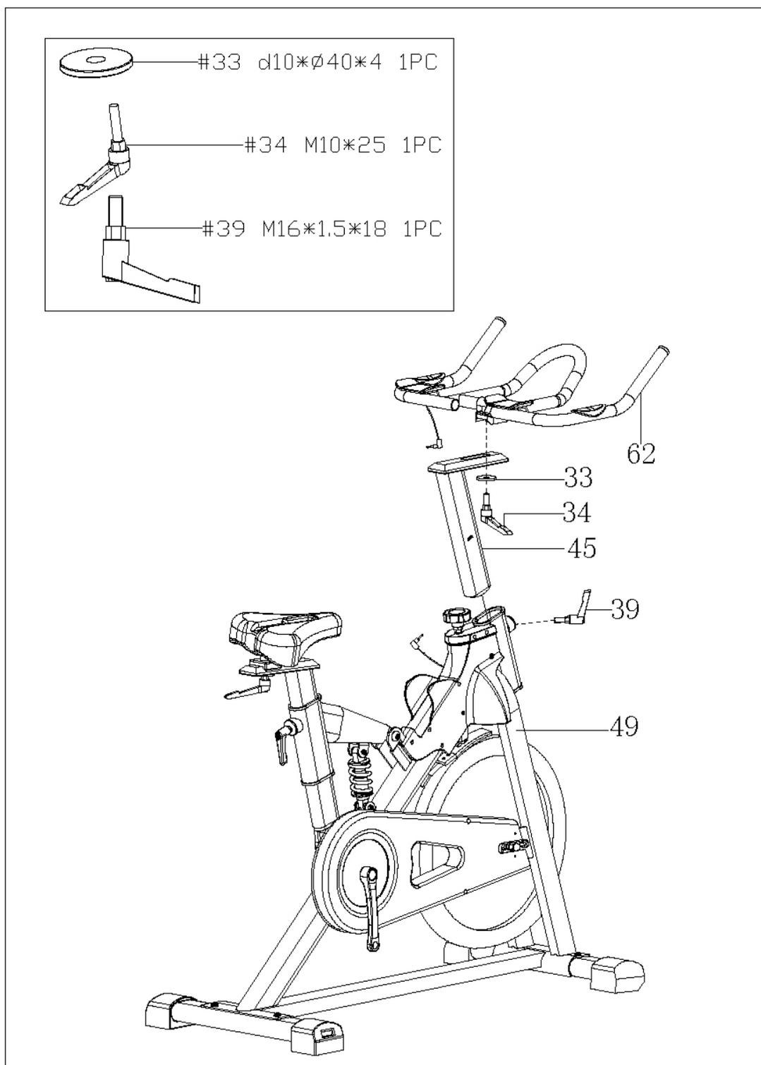
**a** Usare la manopola a L ( 39 ) per attaccare il montante del manubrio ( 45 ) al telaio ( 49 ).
